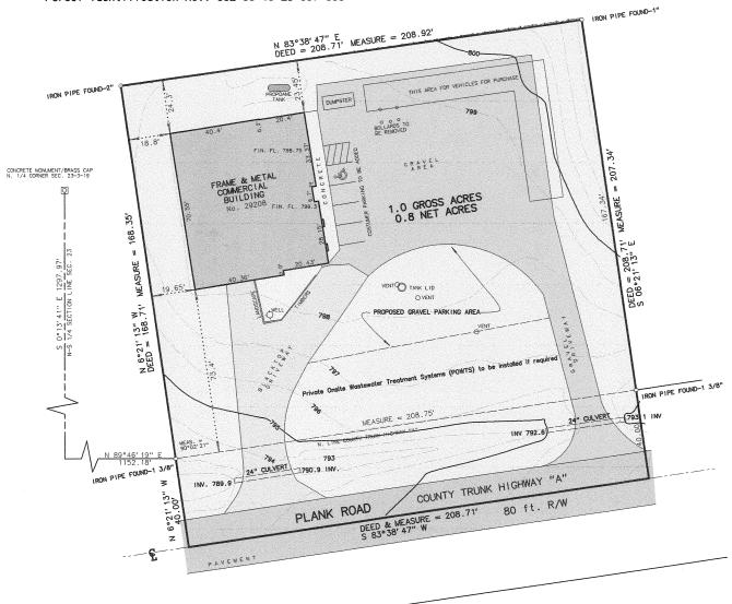
ORTHOMETRIC HEIGHT (GROUND ELEVATION) IS DETERMINED FROM USING GLOBAL NAVIGATION SATELLITE SYSTEM (GNSS), THE VERTICAL DATUM BASIS IS NAVD88 AND THE GEOID MODEL IS GEOID 12B CONUS.
